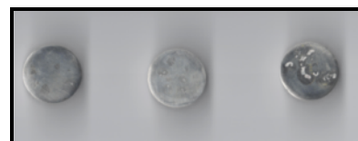
Fig. 11. Ataque localizado sobre el Acero Inoxidable.
