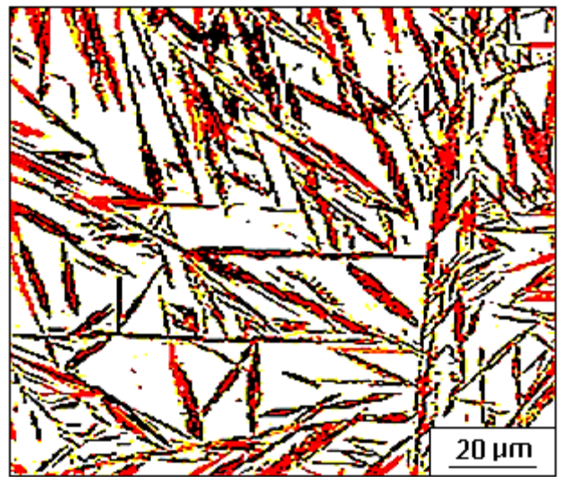
Fig. 11. MES obtenida a -30\text{ °C} ( \approx -27\text{ °C} ). Muestra deformada hasta \varepsilon = 0,16 ( f\alpha' \approx 25\% ).
