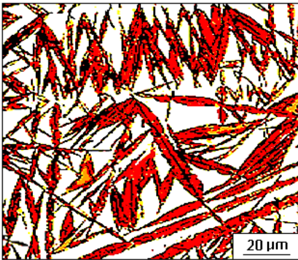
Fig. 10. Mezcla de martensita atérmica y MES en una muestra fracturada a -40\text{ °C} ( \varepsilon = 0,09 ; f\alpha' \approx 48\% ).
