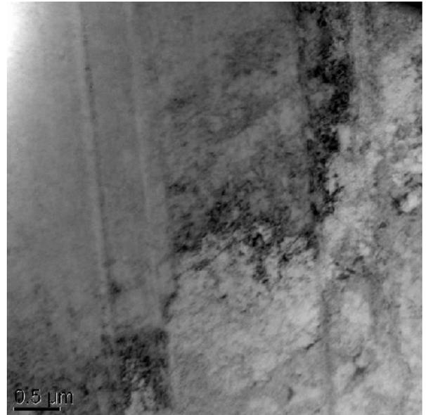
**Fig. 3.** Imagen TEM de la zona nitrurada a 4,7 micrones de la superficie
