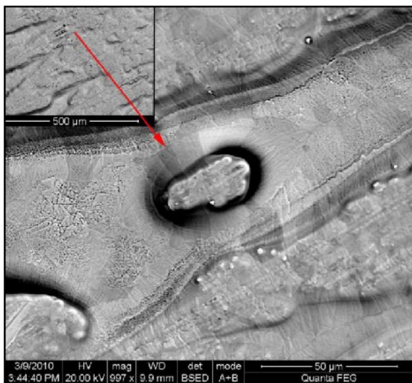
Fig. 2. Imagen SEM de la cinta P mostrando el crecimiento dendrítico de la F. En el centro de la muestra se observa una ramificación aflorando a la superficie.
