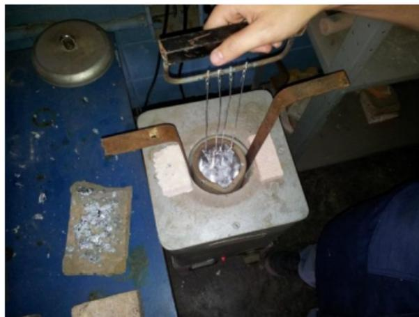
**Fig. 1.** Operación de inmersión de las probetas en el baño fundido de Zn - 7Al.
