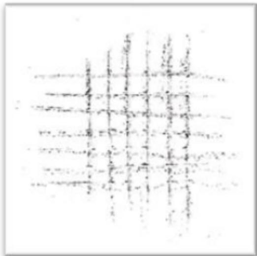
**Fig.3.** Retícula de prueba adherencia según norma ASTM D 3359. [4]
