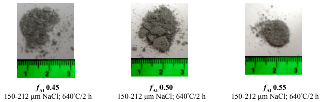
Fig. 5. Aspecto de algunas de las esponjas de aluminio: presión de compactación de 5 MPa
