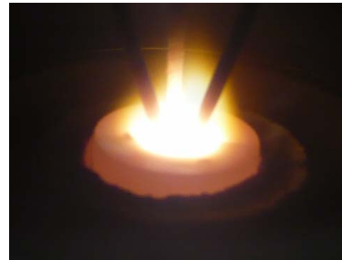
Fig. 4. Imagen tomada del proceso EA-SHS durante la síntesis del compuesto SiC-Al 2 O 3
