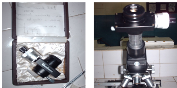
Fig. 3. Sistema óptico para la medición y conteo de grietas en el recubrimiento.
