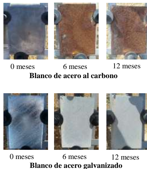
Fig. 15. Inspección visual. Comparación de blancos.
