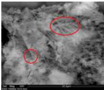
Fig. 7. Imagen de morfología bacteriana sobre el acero.
