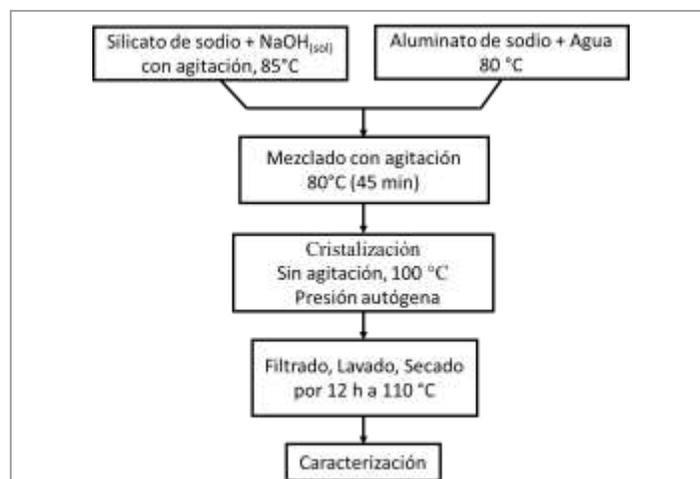
**Fig. 2.** Procedimiento empleado para la síntesis de las zeolitas A.
