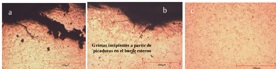
Figura 2. Análisis microestructural por M.O, zona de falla. CT de la superficie de fractura, zona más deformada. a, b) Borde externo 100X, 50X. c) Metal base 100X. d) Análisis químico por EDS del metal.
