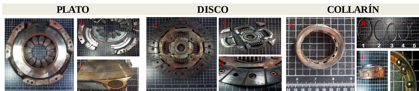
Figura 1. Evaluación macroscópica del kit de embrague. Se observa la vista general y cortes realizados a los tres componentes que conforman el kit (a-i): Vista superior del plato con todos sus elementos (a) y cortes de cada uno de sus elementos (b) y detalle del inserto-plato-carcasa (c); vista superior de los elementos que compone el disco y patrón de corrosión generalizada (d) y cortes realizados a la base de sujeción, remaches, resortes y disco de freno (e-f) y vista superior del collarín y elementos que lo componen (pista externa, pista interna, balines, reten y blindaje) (g-i), detalles del daño de la pista interna (h) y del desgaste en los balines (j).
