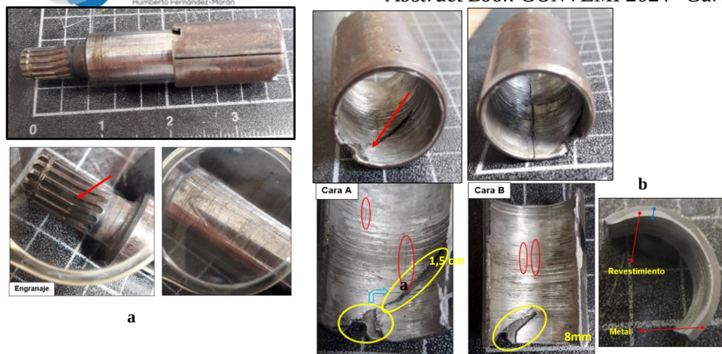
Figura 1. Apariencia macroscópica de los internos de la bomba. a) Eje – engranaje. b) Cojinete, superficie interna y sección transversal.
