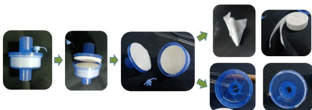
Figura 6: Desmontaje del filtro comercial
