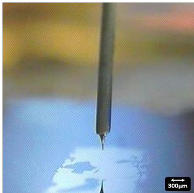
Fig 12. Imagen óptica, tomada con la cámara interna del STM, de una punta de W fabricada por Ataque Electroquímico. La superficie a estudiar en la imagen corresponde a la muestra C.
