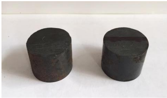
Fig. 1. Muestras de acero AISI 1045 en estado de entrega.
